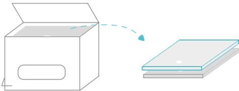
Einlegeplatten zur Höhenregulierung: Bei flachen Produkten Einlegeplatten verwenden. Keine Einlegeplatten bei hohen Produkten und Flüssigkeiten.
